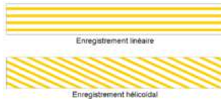
Figure 3: Fonctionnement de l'enregistrement linéaire et hélicoïdal 46
