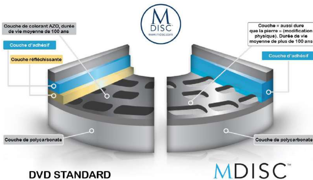
Figure 7: Structure d'un DVD et d'un M-Disc 97
