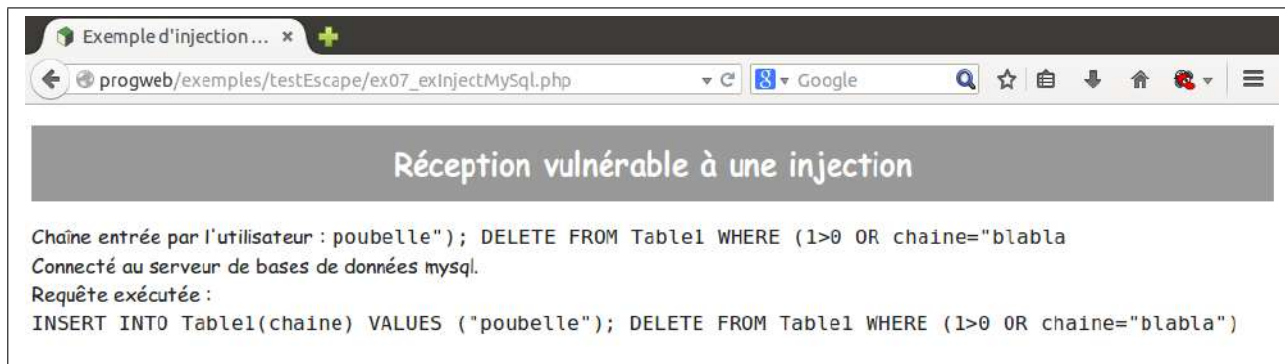
FIGURE 4.13 : Requête exécutée lors de l'injection SQL
