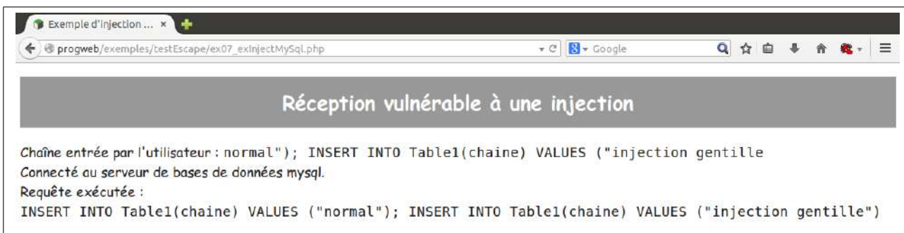
FIGURE 4.10 : Requête exécutée lors de l'injection SQL
