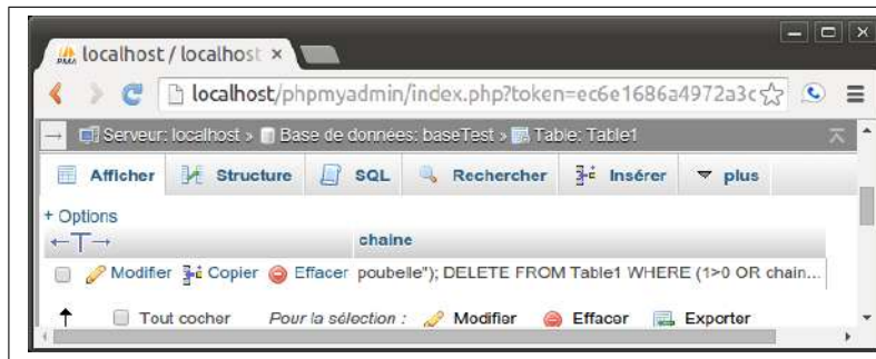
FIGURE 4.16 : Données dans la base après tentative d'injection SQL avec échappement
