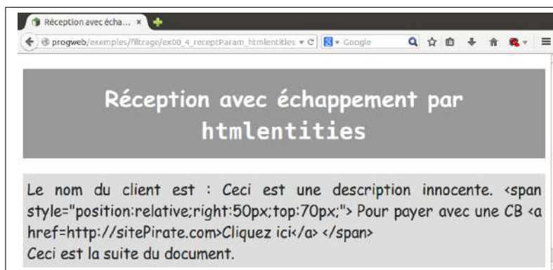
FIGURE 4.5 : L'injection a été évitée par échappement.
