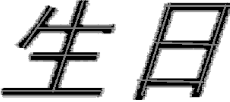
Figure extraite de [Liu2003] (page ??), l'algorithme est utilisé pour la détection de lignes considérées ici comme des lois normales dont la matrice de covariance définit une ellipse dégénérée dont le petit axe est très inférieur au grand axe. Les traits fin grisés correspondent aux classes isolées par l'algorithme RPCL-based local PCA.
