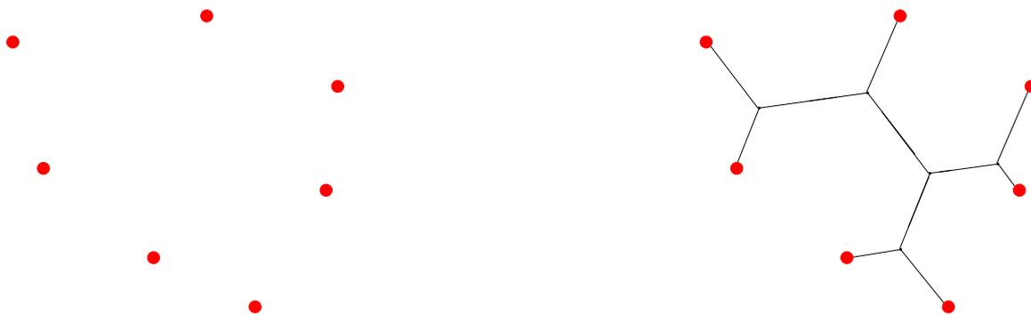
FIG. 4. A gauche, l'input d'un problème de Steiner euclidien, à droite l'output.
