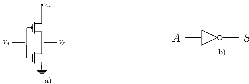
FIGURE 2.6 – a) Une réalisation possible d'une porte NOT en technologie CMOS avec une paire de transistors PMOS et NMOS. b) Symbole normalisé (norme Américaine) d'une porte NOT. Sur ce schéma, on ne représente pas les tensions V_{cc} et la masse qui sont implicites.
