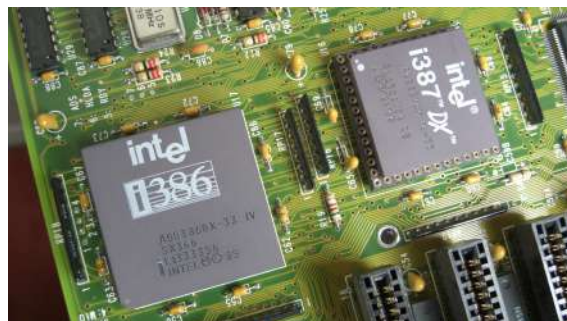
FIGURE 2.24 – Le processeur principal Intel 80386 et son coprocesseur optionnel 80387 réalisant les opérations arithmétiques sur les représentations à virgule flottante. Source :Wikipedia.
