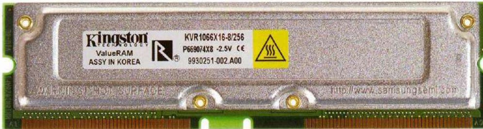
● Sur un module de mémoire RDRAM, les puces sont protégées par une plaque d'aluminium.
