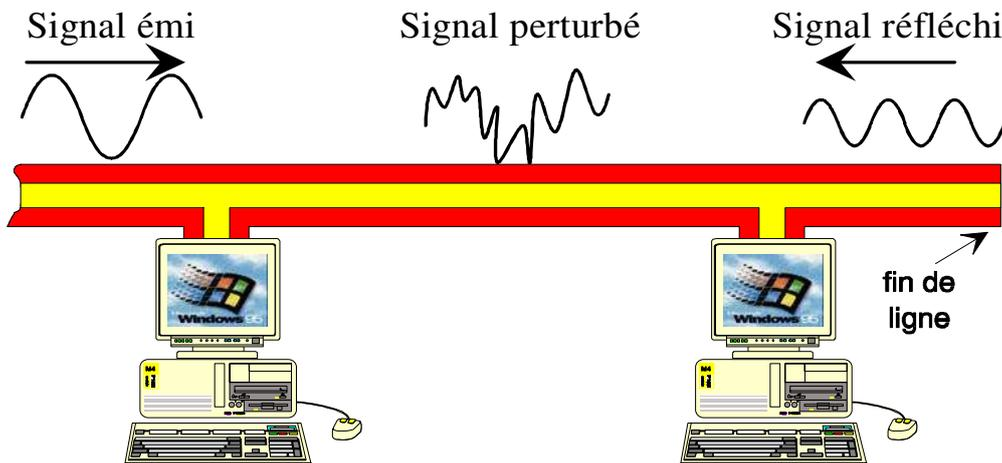
Il est donc nécessaire de placer aux extrémités de la ligne une résistance de terminaison d'une impédance égale à l'impédance caractéristique de celle-ci ( $50 \Omega$  ou  $75 \Omega$ ), ce qui permet l'absorption de l'énergie et évite le phénomène de réflexion.
