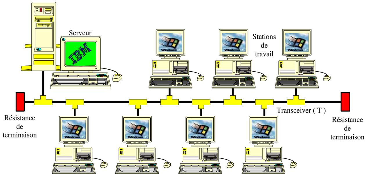
L'inconvénient de cette topologie est que le signal étant émit sur l'ensemble du bus, lorsque celui-ci arrive en fin de ligne l'ensemble de son énergie n'a pas été absorbé, il risque de se produire un phénomène de réflexion du signal.
