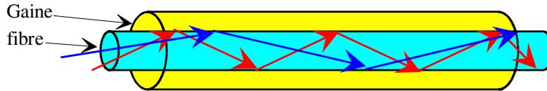
Le diamètre du coeur (fibre) est compris entre 50 et 200 microns.
