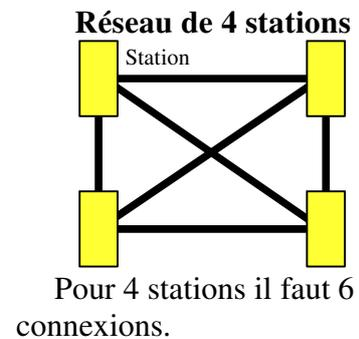
Ainsi le nombre de connexion nécessaire pour connecter les stations dépend de l'équation suivante:  $Nbl = \frac{N \times (N - 1)}{2}$  avec Nbl, le nombre de connexions et N, le nombre de stations. Donc si un réseau comprend 15 stations il faudrait 105 connexions. Ce qui est impossible à câbler d'où l'intérêt des commutateurs.
