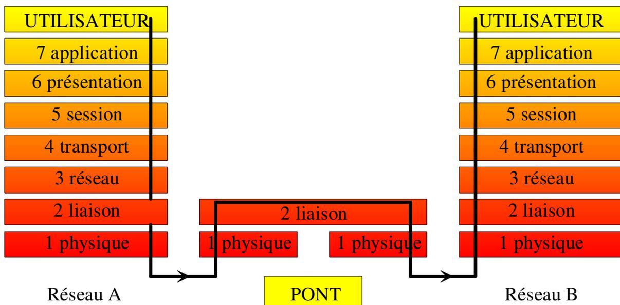
Il existe deux types de pont, les ponts simples et les ponts routeurs, en voici les principales fonctions.
