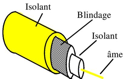
Le câble coaxial a un blindage qui permet de l'isoler des perturbations extérieures.
