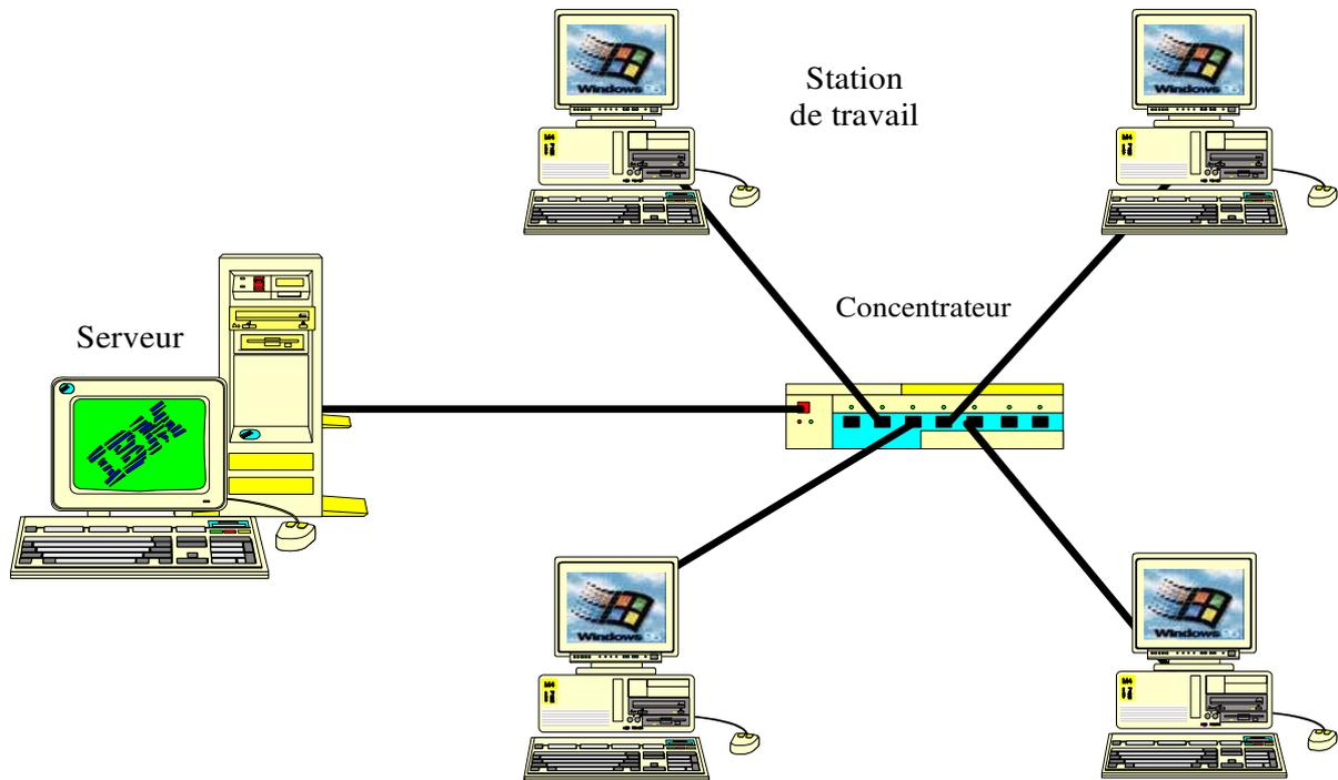
Le câblage du réseau est plus coûteux que celui de la topologie en bus. Il est effectué à l'aide de câble en paires torsadées.
