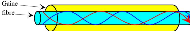
Le diamètre du coeur (fibre) est compris entre 50 et 100 microns.
