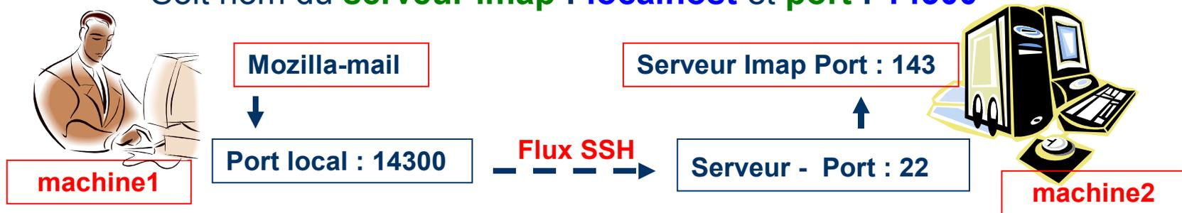
**-L** : spécifie que les données arrivant sur le port 14300 de la machine1 doivent être envoyées sur le port 143 l'hôte distant (machine2)
